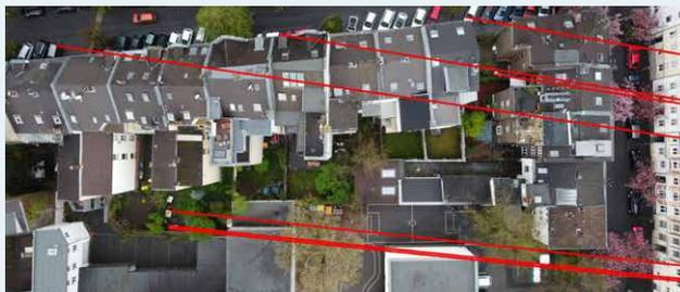
*oben: Der Algorithmus markiert die »Key points« und erkennt diese in verschiedenen Aufnahmen des gleichen Geländes wieder (»Matching«).*
